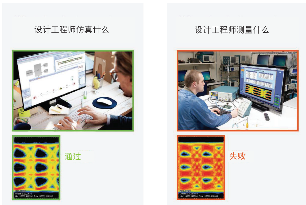
图 3. 由于存在测试夹具、设备及使用不同的 Rx 方法，测量结果与设计仿真不一致。
