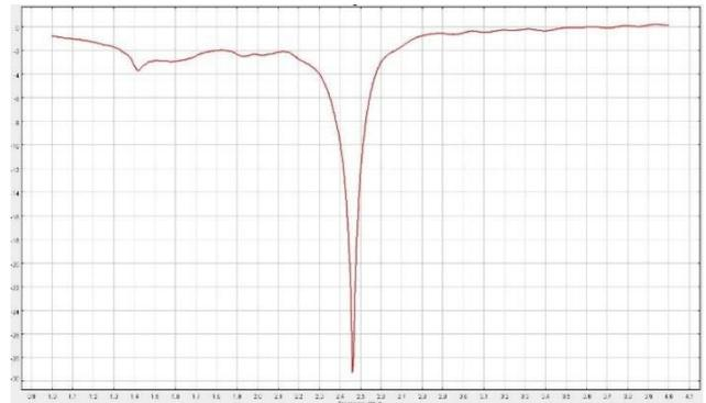
图31: 匹配元件值与相应的反射损耗S<sub>11</sub>图表
