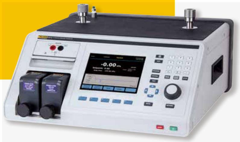
2271A工业压力校准器为校准宽范围的压力计和传感器提供完备、自动化解决方案。得益于其模块式设计，可根据不同需求和预算来灵活配置，并且可通过扩展来满足更多的工作需求。
